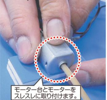
天板(部材①)の裏面中央部にモーター台(部材③)を2枚重ねて、両面テープで貼ります。モーターを、両面テープでしっかりと固定します。モーターの軸がモーター台に掛からないよう注意しましょう。
