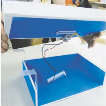
エンビ板と天板を両面テープでしっかりとつけます。底板に電池BOXを両面テープで固定すればゲーム台の完成です。
